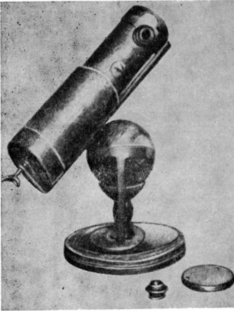
Отражательный телескоп Ньютона. До сих пор устройство всех больших телескопов основывается на идее Ньютона
